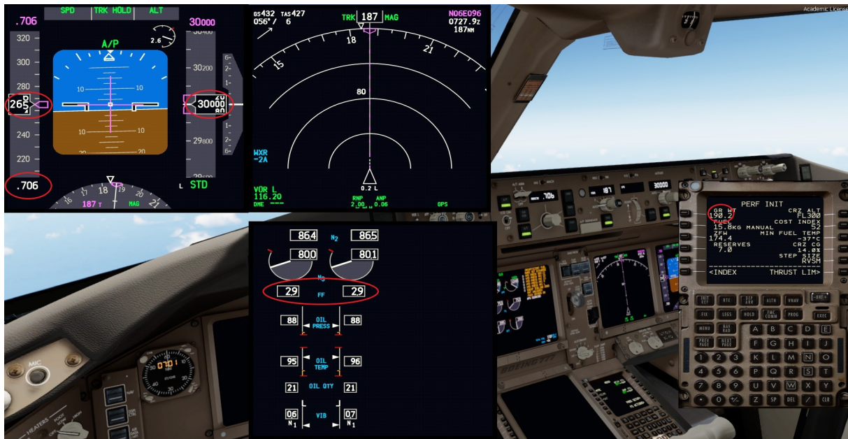
Figure 47: Consommation de carburant modélisée par notre simulateur au FL300 et à Mach 0,706 pour une masse de 190t
