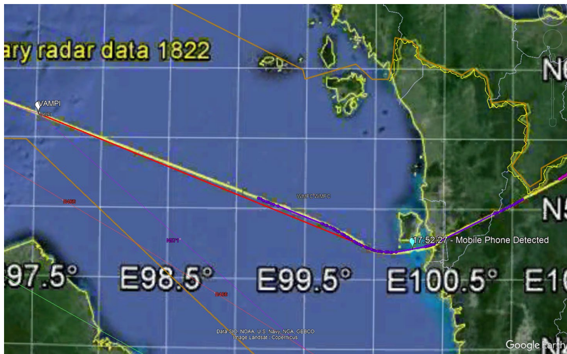
Figure 28: Piste radar primaire civile superposée sur la piste radar militaire du sud de Penang au point de navigation VAMPI (source ATSB [4])
