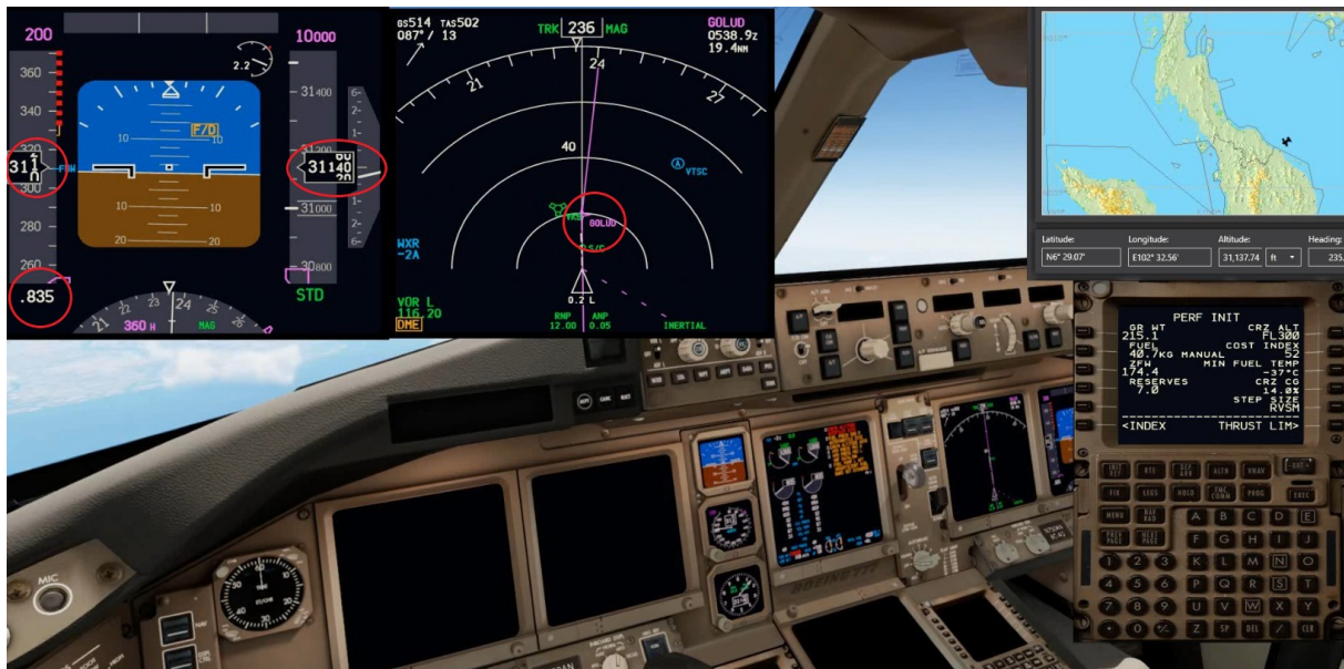
Figure 26: Paramètres de vol dans la dernière partie de la descente vers le FL300
