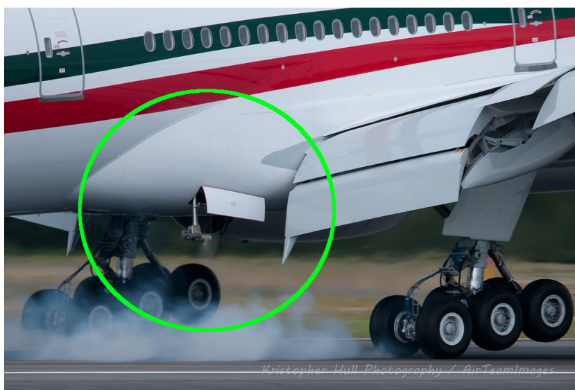
Figure 57: La Ram Air Turbine (RAT) et sa trappe ont été déployées
